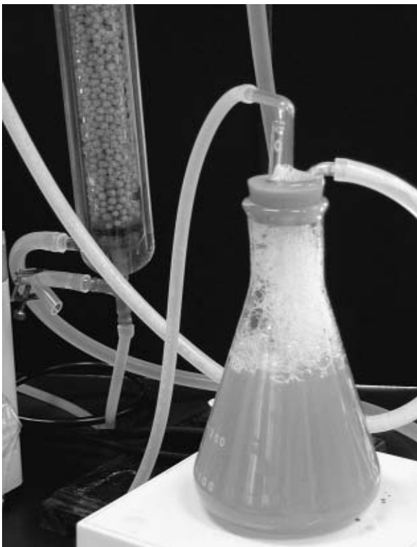
写真3 バイオリアクター内で発生する気泡（充てん槽型）
